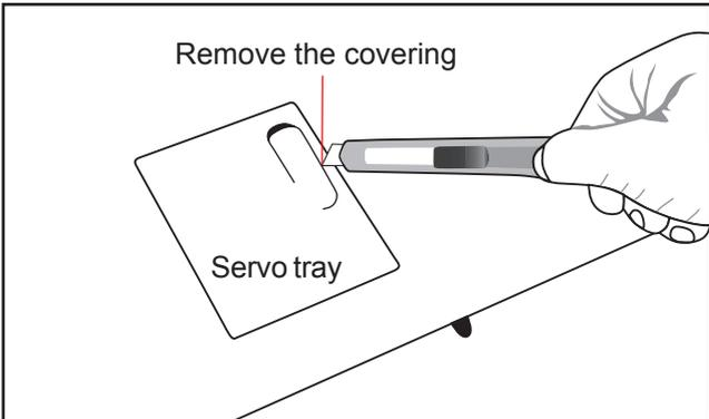
1. INSTALLING THE AILERON SERVOS
