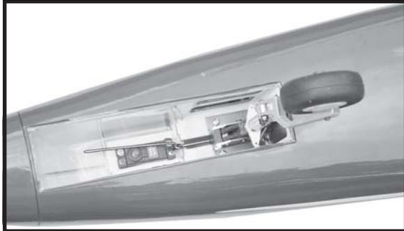
**INSTALLING SERVO NOSE GEAR.**
