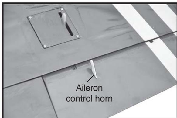
**INSTALLING THE AILERON LINKAGES.**
