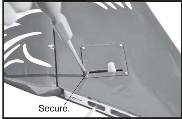
**RUDDER CONTROL HORN INSTALLATION.**
