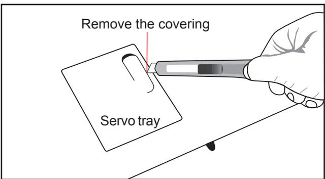
**1. INSTALLING THE AILERON SERVOS**
