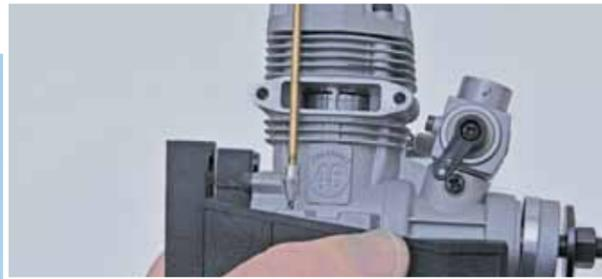
🇩🇪 Halten Sie den Motor fest, und markieren die Position der zwei Montagelöcher auf dem Träger, wie gezeigt. Übertragen sie sorgfältig diese Markierungen auf den zweiten Motorträger. Wichtig: Vergewissern Sie sich, dass Sie die Markierungen korrekt übertragen haben, da Unterschiede hierbei den Schub des Motors beeinträchtigen.
