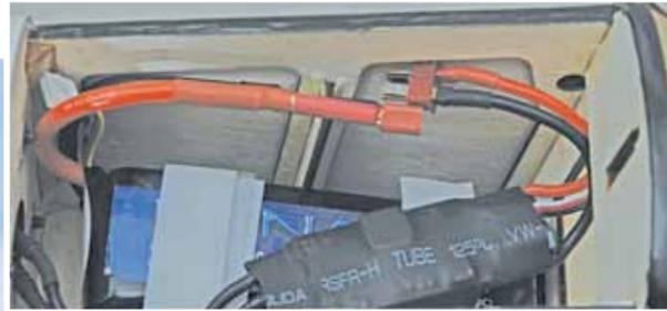
🇩🇪 Legen Sie den Akkuträger mit dem montierten Akku wieder zurück. Dann überprüfen Sie den Akku und den Geschwindigkeitsregler, dass keine Kabel eingeklemmt oder zerdrückt sind.
