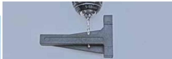
🇩🇪 Bohren Sie vier saubere Löcher durch die Motorträger, damit die mitgelieferten Schrauben hinein passen.
