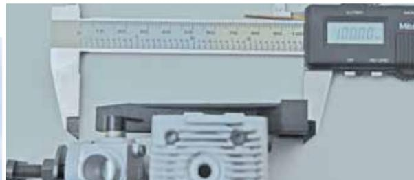
🇩🇪 Der mit dem Wot4 mitgelieferte Motorträger (I/CPack) wurde in zwei Teilen konstruiert. Heben Sie den Motor an einen Träger und bewegen den Motor nach vorne oder nach hinten, bis der Abstand der Vorderseite des Prop. Mitnehmers und der hinteren Fläche des Halters exakt 100 mm beträgt.
