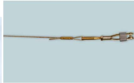
Schneiden Sie den mitgelieferten Zug in zwei gleiche Längen. Dann befestigen Sie einen Gabelkopf und eine Sicherungsmutter an dem Zug, indem Sie diesen durch den Adapter schleifen, und schieben das mitgelieferte Messingrohr über den Verbinder. Mit einem Zange oder Seitenschneider drücken Sie dieses vorsichtig zusammen. Wiederholen Sie dieses auch für die zweite Hälfte des Zuges. Für zusätzliche Sicherheit empfehlen wir Ihnen einen Tropfen Sekundenkleber an der Quetschstelle aufzubringen.
