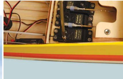
🇩🇪 Bereiten Sie Ihr Gas Servohorn vor, indem Sie einen Gestängeverbinder montieren, wie in Schritt 45 gezeigt. Schieben Sie den Verbinder auf das Gestänge, und befestigen das Ruderhorn. Stellen Sie das Gestänge so ein, dass die mittlere Gashebel Position mit dem Vergaser übereinstimmt, der zu 50% offen ist. Schrauben Sie die Schraube in den Verbinder, und stellen die Vollgas- und Leerlauf- Gasposition ein.
