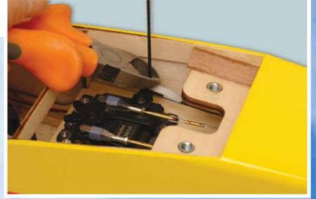
Step 46 Four Stroke Engine Installation / Schritt 46 Einbau eines 4 Takt Motors
