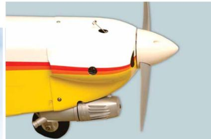
🇩🇪 Schneiden Sie die Fiberglas Motorabdeckung aus, um den Motor und den Schalldämpfer darin unterzubringen. Die Motorhaube sollte die Front des Rumpfes überlappen. Vermessen Sie sorgfältig die Position der Motorhauben Montageblöcke, und übertragen diese Maße auf die Motorhaube. Bohren Sie die Löcher und befestigen Sie die Motorhaube mit den 3 selbstschneidenden Schrauben. Befestigen Sie den Propeller und den Spinner. Das Modell ist komplett und fertig für die finalen Einstellungen.
