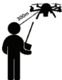
On-Board Kameras, Ferngläser, Nachtsichtgeräte oder ähnliche technische Hilfsmittel fallen nicht unter den Begriff der direkten Sichtweite. FPV Multikopter müssen zu zweit geflogen werden da der Luftraum während des Fluges, insbesondere im Hinblick auf anderen Verkehr, stetig zu beobachten ist.
