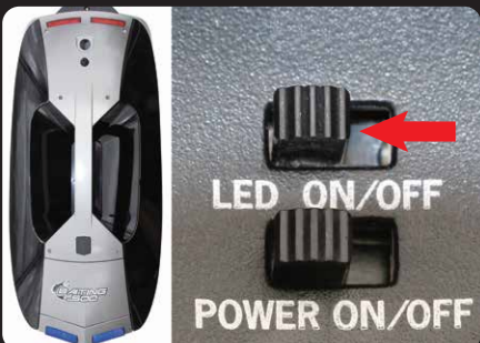
E: "LED" einschalten, blaue LEDs vorne und rote LEDs hinten leuchten.
