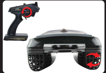
C: Drehen Sie den Drehknopf am Sender gegen den Uhrzeigersinn, wird der linke Propeller stoppen, und der rechte Propeller dreht sich, wie auf dem Bild gezeigt. Das Boot fährt nach links.
