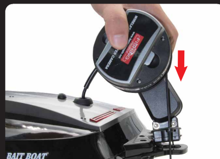
E: Montieren Sie das Kabelaufnahmrad an der hinteren Halterung des Bootes, wie gezeigt.
