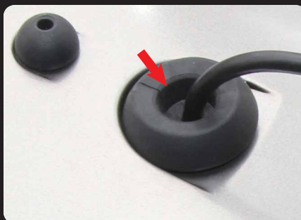
D: Schneiden Sie die den oberen Teil der großen Gummidichtung ab, führen das Kamerakabel ein und montieren alles im großen Loch, damit kein Wasser eindringen kann.
