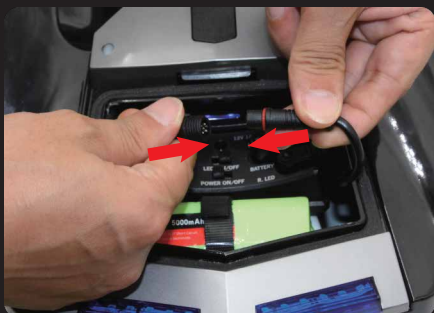
C: Nehmen Sie das Kamerakabel und führen dieses durch das große Loch am Bootsgriff, und gelangen damit in die vordere Kabine. Mit dem wasserdichten Stecker des Empfängers verbinden.
