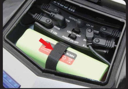
C: Legen Sie den Akku in das Akkufach in der Innenseite der Kabine und befestigen den Akku mit Klettband.
