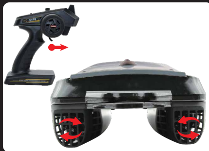
B: Drücken Sie den Gashebel nach vorne, dann wird sich der linke und rechte Propeller drehen, wie auf dem Bild gezeigt, und das Boot fährt rückwärts. (HINWEIS: Die Rückwärtsgeschwindigkeit ist niedriger als die Vorwärtsgeschwindigkeit).
