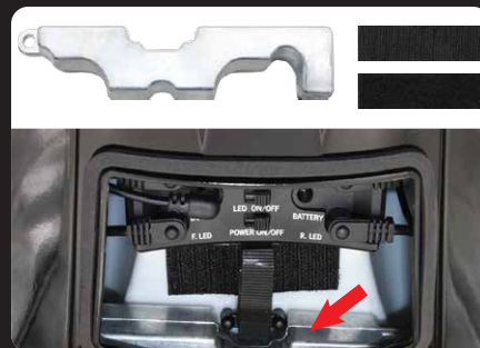
B: Verwenden Sie die Klebestreifen auf dem Ausgleichsgewicht, um dieses Ausbalanciert in der Innenseite der vorderen Kabine zu montieren.
