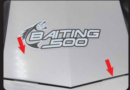
G: Beziehen Sie sich auf das Foto, um die Abdeckung auf der Kabine zu installieren. Richten Sie die Luke aus und drücken diese gleichmäßig in beide Aufnahmen.
