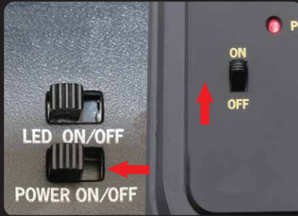
E: Immer zuerst den Sender einschalten (rotes Licht am Sender geht an). Dann schalten Sie den Empfänger ein (das Licht an der Empfängerbox leuchtet blau). F: Jetzt verbindet sich der Sender mit dem Boot und Sie fahren mit dem nächsten Schritt fort.
