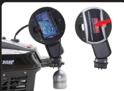
G: Installieren Sie die Batterie in der Innenseite des Kabelaufnahmrades, und schließen das Batteriefach. H: Jetzt können Sie die Bilder auf dem Display sehen.
