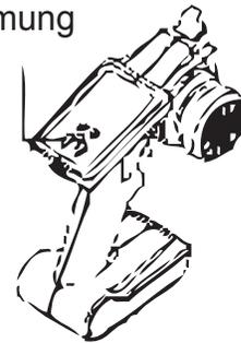
6. Wenn das Boot beim Fahren nach rechts zieht, drücken Sie die linke Rudertrimmung solange bis das Boot geradeaus läuft
