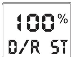
**Set up für Servo Stellwinkel (ST).** Drücken Sie die linke Taste(<) der MENU Funktion (3 Mal im Hauptmenü drücken), bis Sie \*\*\* D/R ST auf dem Bildschirm sehen. Dann drücken Sie die DATA Funktionstaste links (+) oder rechts (-), um den Parameter des Servo Stellwinkel zu verändern. (Bildschirm zeigt 100% D/R ST an).
