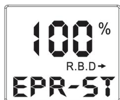
**NOTIZ:** Bei dieser Funktion wird der Lenkservoweg auf einen breiteren oder schmaleren Bereich eingestellt, daher wird auch der Lenkwinkel für das rechte, oder das linke Rad auf den gewünschten Winkel eingestellt.
