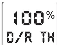
**Set up für Gasservo (TH), Vorwärts- und Rückwärtsfunktion.** Drücken Sie die linke Taste(<) der MENU Funktion (3 Mal im Hauptmenü drücken), und drücken dann einmal die rechte Taste (>) der MENU Funktion, bis Sie \*\*\* D/R TH auf dem Bildschirm sehen. Dann drücken Sie die DATA Funktionstaste links (+) oder rechts (-), um den Parameter des Gas Stellwinkel zu verändern. (Bildschirm zeigt 100% D/R TH an).
