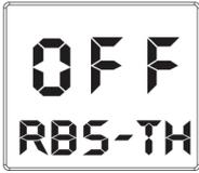
**Einstellung des ABS Bremssystem.** Drücken Sie die linke Taste(<) der MENU Funktion (5 Mal unter dem Hauptmenü drücken). Das Display zeigt \*\*\*ABS-TH an. Um EIN- oder AUSZUSCHALTEN drücken Sie die DATA Funktionstaste links (+) oder rechts (-). Im EINGESCHALTENEM Status wird verhindert, dass die Reifen, während dem Bremsen nicht durch drehen. (Bildschirm zeigt \*\*\* ABS-TH an).
