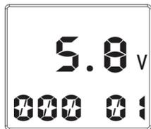
Schalten Sie den Sender ein, dann werden Sie ein „Beep“ Ton (einmal Beep) hören, und das LCD Display zeigt die voreingestellte Standard Parameter BATT Staus Mode (Hauptmenü) an.
