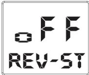
**Einstellung der Lenk- Servo- Richtung.** Drücken Sie die linke Taste(<) oder die rechte Taste (>) der MENU Funktion (einmal unter dem Hauptmenü drücken), bis Sie "\*\*\* REV &ST" sehen. Um EIN- oder AUSZUSCHALTEN drücken Sie die DATA Funktionstaste links (+) oder rechts (-) (Bildschirm zeigt OFF REV-ST an).
