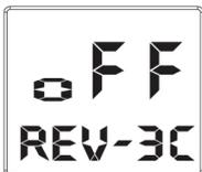
**3. Kanal einstellen.** Drücken Sie die linke Taste(<) der MENU Funktion(einmal unter dem Hauptmenü drücken), und drücken dann zweimal die rechte Taste (>) der MENU Funktion bis Sie \*\*\*REV-3C sehen. Um EIN oder AUSZUSCHALTEN drücken Sie die DATA Funktionstaste links (+) oder rechts (-) (Bildschirm zeigt OFF REV-3C an).
