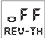
**Einstellung der Parameter für Gaswegumkehr.** Drücken Sie die linke Taste(<) der MENU Funktion (einmal unter dem Hauptmenü drücken), und drücken dann zweimal die rechte Taste (>) der MENU Funktion bis Sie \*\*\*REV-TH sehen. Um EIN- oder AUSZUSCHALTEN drücken Sie die DATA Funktionstaste links (+) oder rechts (-) (Bildschirm zeigt OFF REV-TH an).
