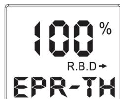
**NOTIZ:** Bei dieser Funktion, wird der Stellwinkel des Gasservos bei Nitro- (Benzin) betriebenen Modellen eingestellt (weiter oder kleiner). Bei Elektromodellen mit elektronischem Fahrtenregler (ESC) bezieht sich diese Funktion auf die Geschwindigkeitseinstellung (schneller oder langsamer).
