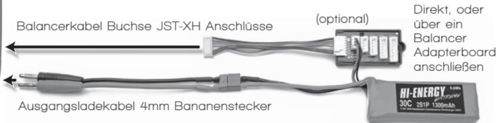
Die Hauptkabel des Akkus müssen zusammen mit dem Balancerkabelstecker angeschlossen werden, bevor Sie den Akku laden, wie gezeigt.
