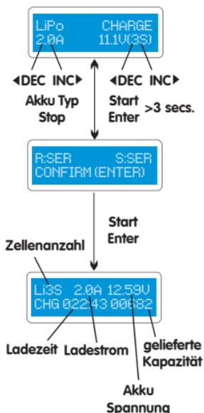
Auf der linken Seite in der ersten Zeile wird der Akkutyp angezeigt, den Sie beim Set Up ausgewählt haben. Der Wert auf der linken Seite in der zweiten Zeile zeigt den Ladesstrom an, und auf der rechten Seite in der zweiten Zeile wird die Spannung des Akkupacks angezeigt. Nachdem Sie Strom und Spannung eingegeben haben, drücken Sie den Start/Enter Knopf und halten diesen für 3 Sekunden, um den Vorgang zu starten. (Ladestrom: 0.1~6.0A, Spannung: für 1-6 Zellen)
