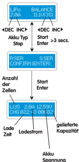
Der Wert auf der linken Seite in der zweiten Zeile zeigt den Ladestrom an und der Wert auf der rechten Seite in der zweiten Zeile zeigt die Gesamtspannung des Akkupacks an.
