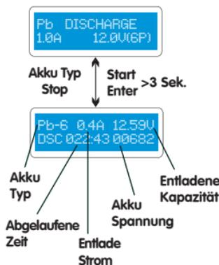
Stellen Sie den Entladestrom auf der linken und die Endspannung auf der rechten Seite ein. Der Entladestrom bewegt sich von 0.1 bis 1.0A. Um den Prozess zu starten, drücken und halten Sie den START/ENTER Knopf für mehr als 3 Sekunden.
