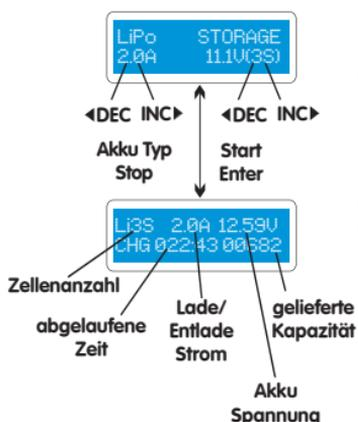
Sie können den Strom und die Spannung des zu ladenden Akkus einstellen. Der Strom wird zum Laden oder Entladen des Akkus benutzt, um das erforderliche Spannungsniveau zur "Lagerung" zu erreichen.
