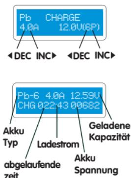
Stellen Sie den Ladestrom auf der linken, und die nominelle Spannung des Akkus auf der rechten Seite ein. Der Ladestrom bewegt sich von 0.1 bis 6.0A und die Spannung sollte mit der des zu ladenden Akkus identisch sein. Beginnen Sie mit dem Ladeprozess, indem Sie den START/ENTER Knopf für mehr als 3 Sekunden drücken und halten.
