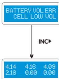
Der Prozessor findet, dass die Spannung einer Zelle im Lithium Akkupack zu niedrig ist.
