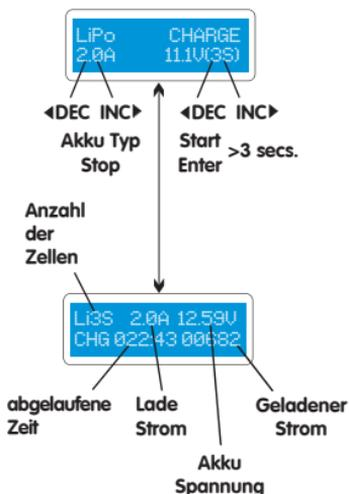
Sie können den Ladestrom und die Akku-Spannung eingeben. Während des Drückens von der Start/Enter Taste wird die Spannung angezeigt. Um die Angaben zu bestätigen und den Ladevorgang zu beginnen, drücken Sie die Start/Enter Taste erneut.
