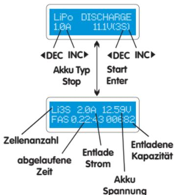
Der Wert des Entladestroms auf der linken Seite der Anzeige sollte zur maximalen Sicherheit 1C nicht überschreiten. Die Endspannung auf der rechten Seite, sollte nicht unter dem empfohlenen Spannungsniveau des Akkuherstellers, zum Tiefentladen sein.
