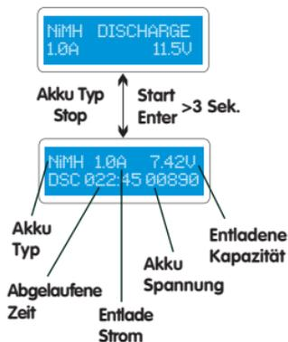
Stellen Sie den Entladestrom auf der linken und die Endspannung auf der rechten Seite ein. Der Entladestrom bewegt sich von 0.1 bis 1.0A, die Endspannung bewegt sich von 0.1 bis 25.0V. Um den Prozess zu starten, drücken und halten Sie den START/ENTER Knopf für mehr als 3 Sekunden.
