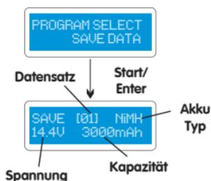
Die Einstellwerte in dieser Anzeige beeinflussen nicht den Lade - oder Entladeprozess. Sie zeigen lediglich die Daten des Akkus an. Die folgenden Anzeigen zeigen automatisch die von Ihnen eingestellten Werte zu dem passenden Akku an. Das Beispiel zeigt einen NiMH Akku mit 12 Zellen und 3000mAh Kapazität.
