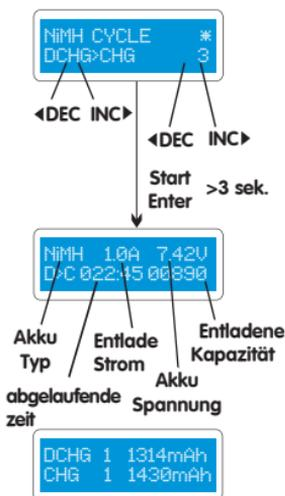
Stellen Sie die Reihenfolge auf der linken und die Anzahl der Zyklen auf der rechten Seite ein. Sie können diese Funktion zum balancieren, auffrischen und formatieren des Akkus verwenden. Um zu vermeiden, dass die Temperatur des Akkus steigt, wird es eine kurze Kühlperiode (bereits bei den 'Benutzer Einstellungen' eingestellt) nach jedem Lade - und Entladeprozess geben. Die Anzahl der Zyklen bewegen sich von 1 bis 5.
