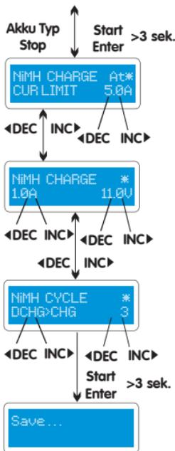
Einstellung des Ladestroms im manuellen Lademodus oder das Limit des Stroms im automatischen Lademodus. Jeder Mode kann gewechselt werden, indem Sie den INC und DEC Knopf zur gleichen Zeit drücken, wenn das dementsprechende Feld aufleuchtet.
