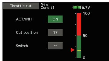
„Wenn der Gashebel in Leerlaufposition ist, Abschaltposition einstellen, bis der Motor dauerhaft AUS ist; aber die Gashebelanlenkung nicht blockiert.“
