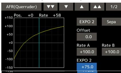
Die Verwendung einer EXP2-Kurve ist beim Hochlauf des Motors oder sonstigen Faktoren der Motorsteuerung mitunter sinnvoll.
