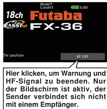
Werden die Schalter in umgekehrter Reihenfolge ausgeschaltet, kann das Modell unerwartet steuerlos werden und eine erhebliche Gefahr darstellen.
