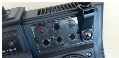
Für die Befestigung der Sendeantenne werden zwei der Schalterlöcher an der Frontseite des Senders benötigt. Die klare Abdeckplatte kann dabei verbleiben, es müssen lediglich die Löcher ausgebrochen werden.
