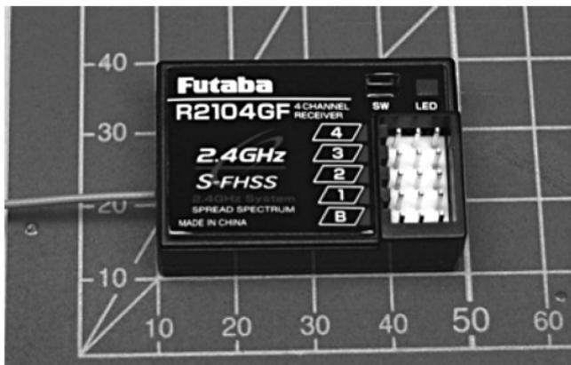
Kleiner, leichter 2,4 GHz FHSS/ S-FHSS 4-Kanal Empfänger mit Frequency-Hopping Technologie
