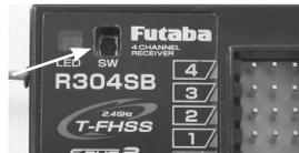
Durch Drücken der Taste "SW" wird im Empfänger automatisch die individuelle Codenummer des Senders gespeichert. Durch diese "Bindung" reagiert der Empfänger nur noch auf die Signale des angebondenen Senders.
