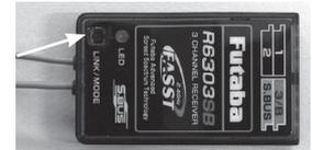
Durch Drücken der Taste "Link/Mode" wird im Empfänger automatisch die individuelle Codenummer des Senders (130 Millionen Codes) gespeichert. Durch diese "Bindung" reagiert der Empfänger nur noch auf die Signale des angebundenen Senders.
