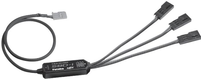
Der S.BUS PWM Adapter, bietet die Möglichkeit das neue S.BUS-System auch bei bestehenden Modellen bzw. mit vorhandenen Servos einzusetzen. Adapter zum Anschluss von 3 Standard-Servos an den S.BUS. Wandelt das Signal für jeden Ausgang separat von S.BUS auf PWM um. Den Ausgängen kann eine gleiche oder unterschiedliche Kanalnummern zugeordnet werden. Die Kanalnummern-Zuordnung erfolgt entweder über den PC mit der PC-Link Software oder dem PC-unabhängigen handlichen S.BUS Programmierer SBC-1.
