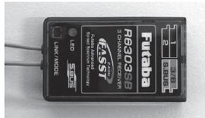
Die Servokanäle sind in 7 Gruppen den Ausgängen Port 1 und 2 zuteilbar, wodurch die Ausgangsbelegung in Grenzen frei gewählt werden kann. Zudem besitzt der R6303SB Empfänger eine Umschaltung wodurch die Impulsabgabe für Digitalservos noch schneller erfolgen kann, was zu einer noch kürzeren Reaktionszeit führt.
