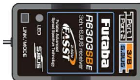
Durch Drücken der Taste „Link/Mode“ wird im Empfänger automatisch die individuelle Codenummer des Senders (130 Millionen Codes) gespeichert. Durch diese „Bindung“ reagiert der Empfänger nur noch auf die Signale des angebundenes Senders.
